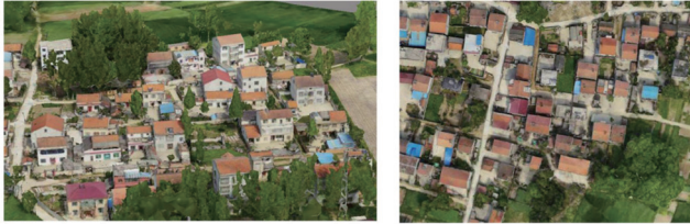
图2 倾斜摄影测量(倾斜视角和垂直视角)
