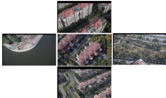
图5 倾斜五镜头影像畸变改正
