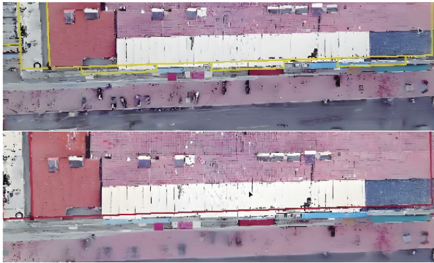
图2 基于大比例尺数字线划图采集建筑物轮廓
