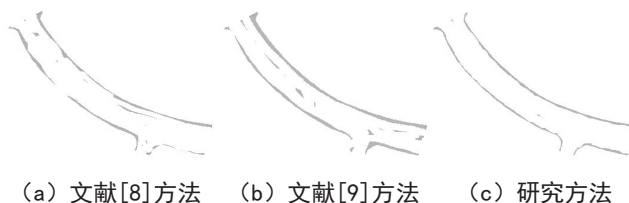
图6 不同方法的弯曲路段边界提取结果
