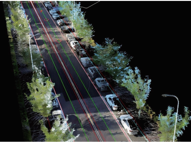
图5 移动背包补充测量点云成果
