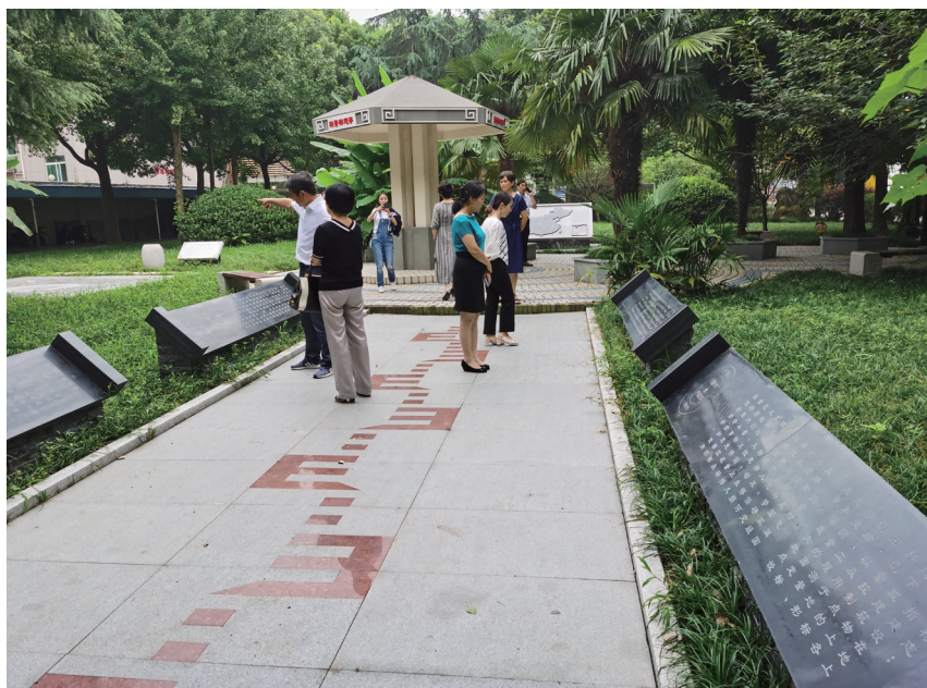
● 图为浙江省平湖市景观型测量标志。它是一座二等水准点，坐落在平湖市新埭镇中心小学校园内，主要由一幅中国地图浮雕、一座测量标志亭、一盏西瓜灯造型的明标、一处司南底座的暗标、一条测绘标尺步道组成。（平湖市自然资源和规划局供图）
