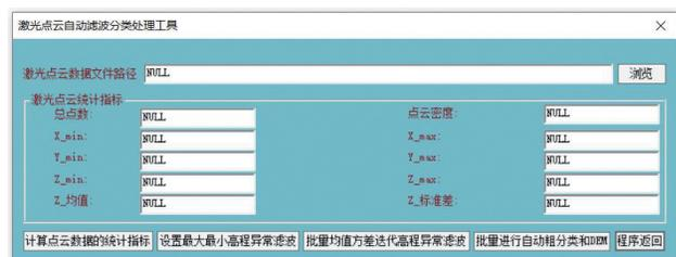
图2 点云自动滤波分类处理模块
